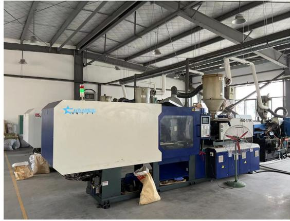
注塑机及废气收集管道
