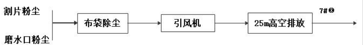
图 6-4 磨水口和割片粉尘处理设施监测点位示意图
