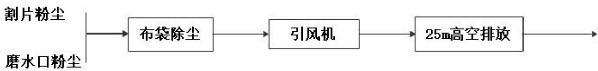
图 3-4 割片和磨水口粉尘工艺流程图
